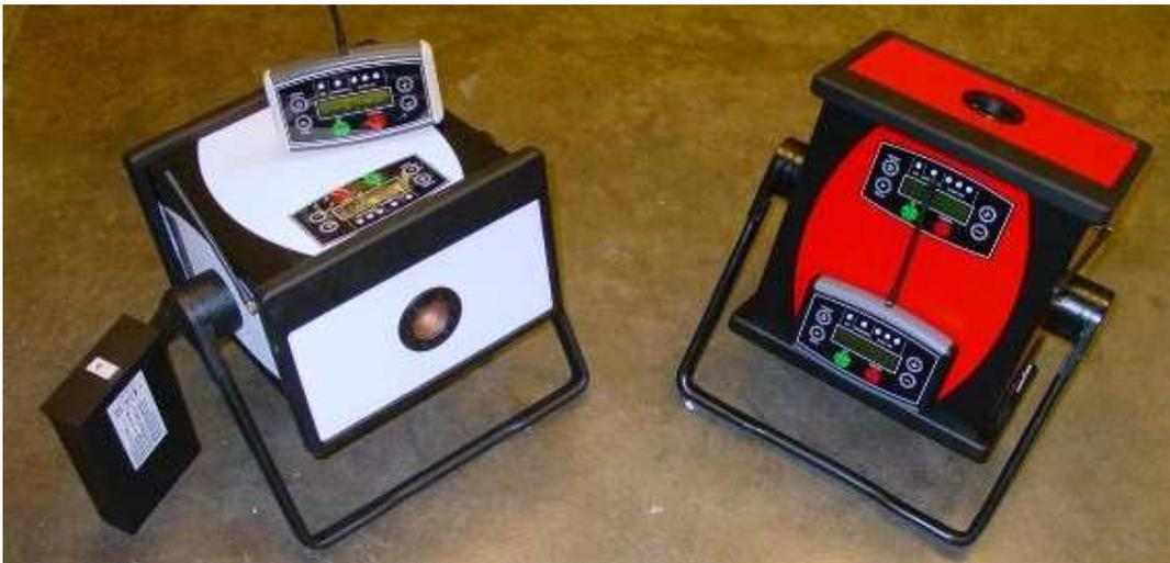
Lors de la dernière étape de production, le générateur subit une série de tests qui prennent environ 2 jours (formation du vide dans le tube, calibration en fréquence, tests en durée sous diverses tensions d'entrée, tests sur batteries, ...). Ces tests sont actuellement réalisés de manière manuelle.
